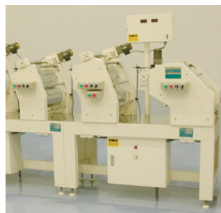
ロールギャップ自動方式 ロールのスキマを表示
