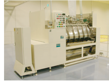
UT-15-V 真空ミキサー 多種多様な皮作りが可能になる 特色の在る皮作りに
