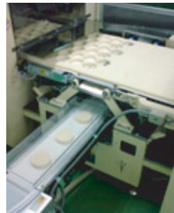
UT-100-B 自動折畳打抜機(自動包装タイプ) 生皮製造から包装及び残皮処理までを自動化
