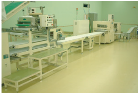
UT-100-B 自動折畳打抜機(自動包装タイプ) 生皮製造から包装及び残皮処理までを自動化
