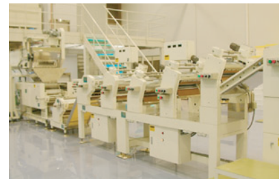
UT-50 連続圧延機(中空モーター仕様) 自動制御方式による広範囲調整能力 (ロール及び段数は多種組み合わせ可能)
