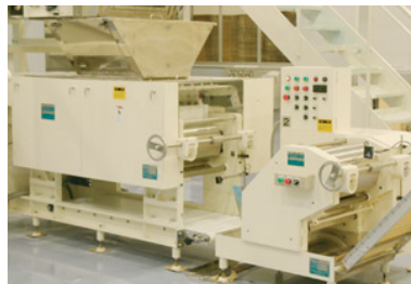
UT-40 複合圧延機(中空モーター仕様) 生地の量をセンサーで制御 タルミを自動制御で簡単操作
