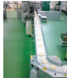
UT-100-B 自動折畳打抜機(自動包装タイプ) 生皮製造から包装及び残皮処理までを自動化
