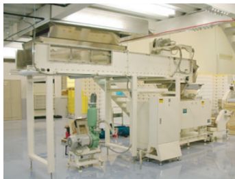
UT-25 生地熟成コンベアー 生地を熟成しながら順番に供給する
