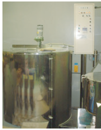
UT-3 冷温水機 練水の温度管理に
