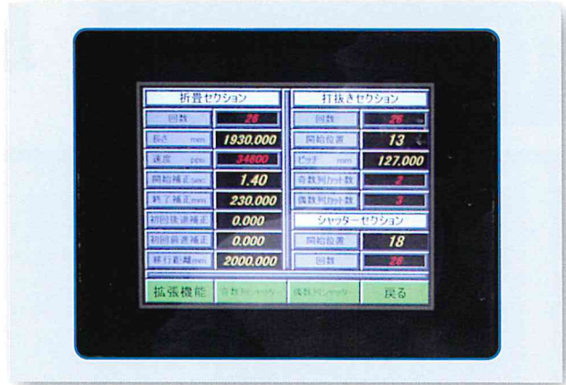
打ち抜き操作パネル
